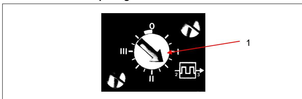
Taktzeit verringern: Einstellschraube (1) im Uhrzeigersinn drehen.
